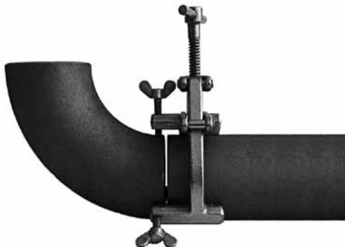
Pour centrer et serrer avec précision des tubes sans limitation de longueur ainsi que des coudes, des brides, des raccords en T, des réducteurs et diverses pièces préformées sur des tubes. Ces tâches peuvent être exécutées sans nécessiter l'intervention d'un assistant. La soudure est accessible de tous les côtés. Le fin ajustement des diamètres de tube s'effectue à l'aide des vis à ailettes.
